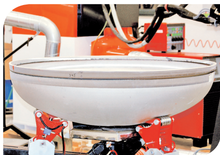
HST CREATIVE ACU Bevel - úkosování nerezových den tlakových nádob
