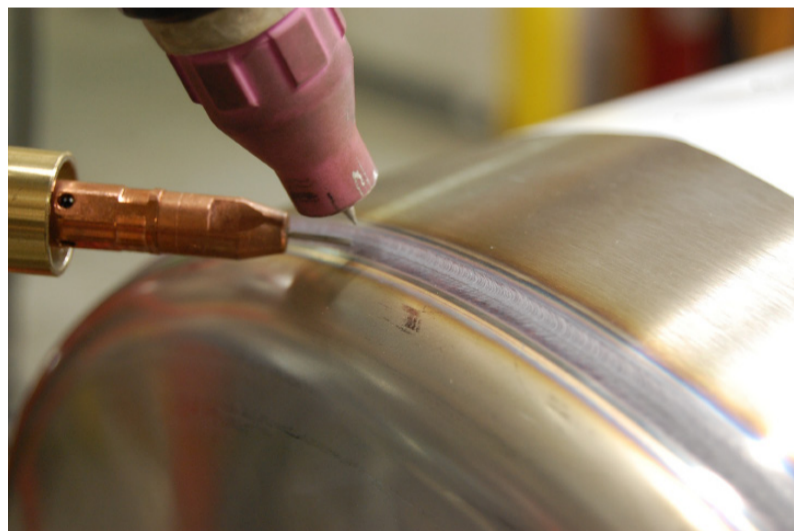
HWR 3152.108.H Mk.I vybavený jedním hořákem MIG (Impulzní inverter CEBORASTAR PULSE 3840)
